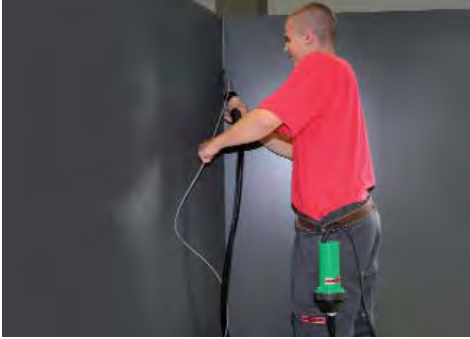
MINOR-puhallin DIODE PID:n ilmansaantiratkaisuna
