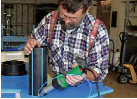
Muovatus osan hitsaaminen TRIAC PID:llä ja pistoliittimellä varustetulla pikahitsaussuuttimella.
