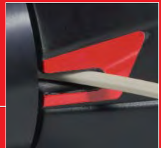
Molemmen puolinen kiertymätön langan sisäänotto
