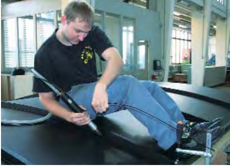
Kätevää hitsausta pienikokoisella ja kevyellä DIODE PID:llä.
